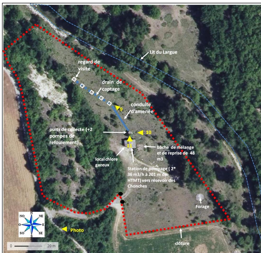
Figure 11 : vue aérienne du captage de la source et du champ captant de La Fare
